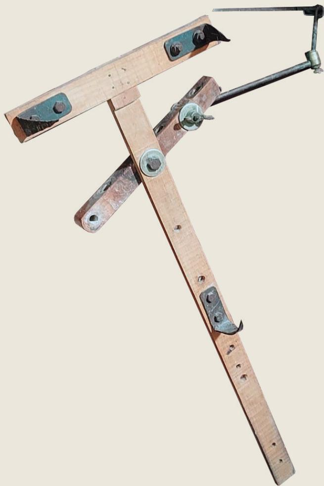
La máquina de sacar puntos o puntómetro es una herramienta de medición utilizada por los escultores y canteros para copiar con exactitud los modelos de escayola, terracota o de otros materiales sólidos, a la madera o piedra. El instrumento consta de varias barras de metal y articulaciones que se pueden colocar en diferentes orientaciones señalando un punto y luego se fija. En realidad no es una máquina, y su nombre deriva del italiano “*macchinetta di punta*”.
